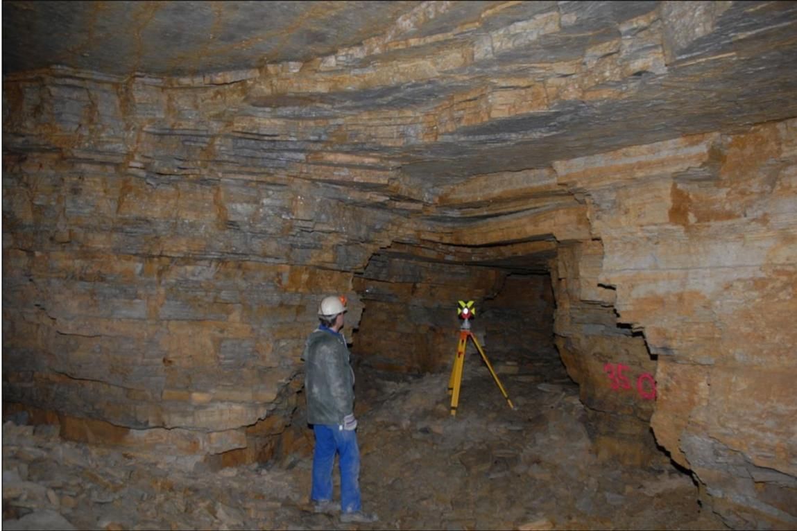
Abb.3 : Vermessungsarbeiten in den Kammer-Pfeiler-Abbauen
